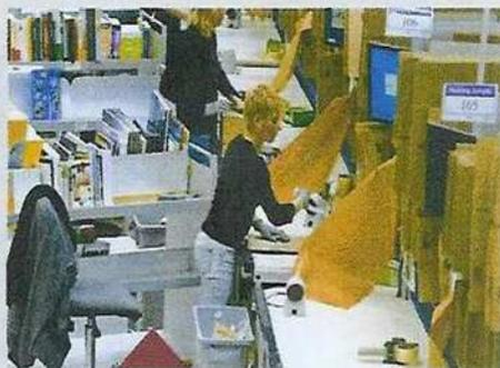
**5 L'emballage** Les opérateurs voient apparaître sur leur écran le type de boîte correspondant à chaque commande. Les paquets sont conçus en interne pour être fermés en quelques secondes.
